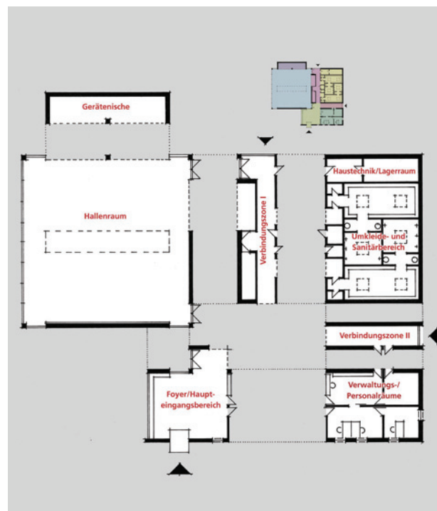
Funktionsmodule des Raumsystems der Turn-Mehrzweckhalle
