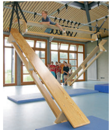
Abb.4/5: Höhenverstellbares Rohrsystem zur Verankerung von Bewegungsgeräten, Raumteilern, Rutschen, Leitern, u. ä. (Gebr. HAGEDORN, Bad Essen)
